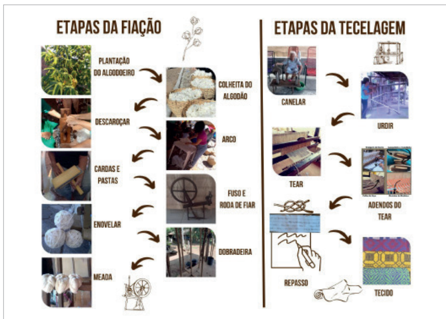
Figura 2 – Etapas do processo de fiação e tecelagem artesanal. Fonte: Fotografias e organização das autoras (2023).
